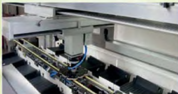
Осевые системы линейных двигателей для высокоскоростной обработки поливиниловых заготовок
