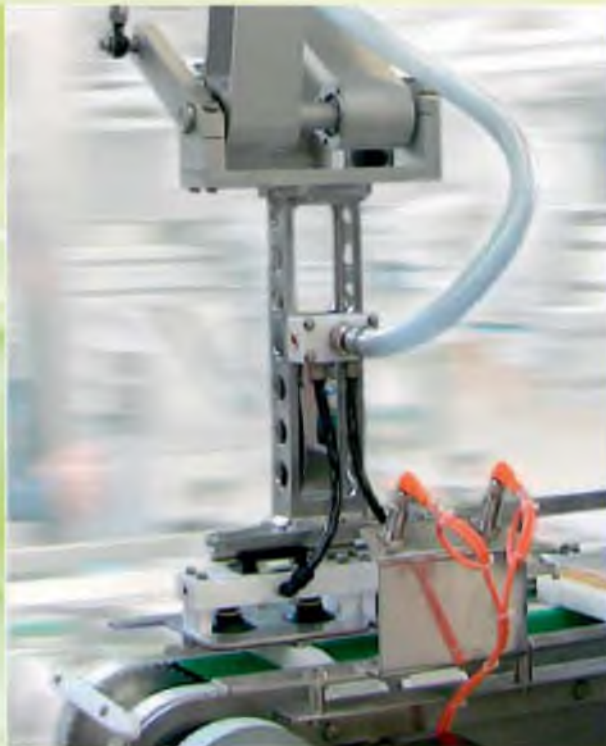
Робот Delta-2 — захват и перенос, управляемые контроллером Trajexia
